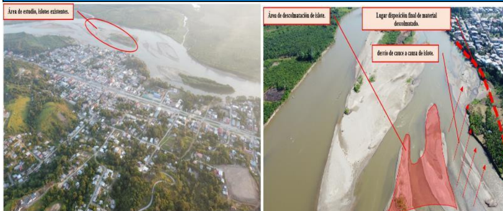
FIGURA N°01 y N°02: La colmatación del cauce ha elevado peligrosamente el nivel de la rasante del río, y la presencia de las piedras, representa RIESGO MUY ALTO PARA LA: POBLACION, VIVIENDAS, INSTITUCIÓN EDUCATIVA INICIAL Y PRIMARIA, PUESTO DE SALUD, SISTEMA ELECTRICO, SISTEMA DE SANEAMIENTO, porque las próximas avenidas del río, a consecuencia del PELIGRO INMINENTE DE INTENSAS PRECIPITACIONES PLUVIALES Y FENÓMENO DEL NIÑO, van a generar un aumento del caudal y ponen en alto nivel de riesgo de sufrir daños por desborde e inundación.
